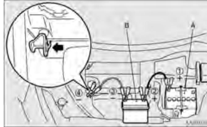
5. Diğer takviye kablosunun bir ucunu takviye aküsünün negatif (-) kutup başına ve diğer ucunu da aküsü boşaltılmış durumdaki aracın motor bloğuna, aküden en uzak noktaya bağlayın.
